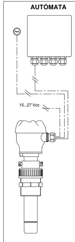
Conexión a través del relé de potencia SHR
