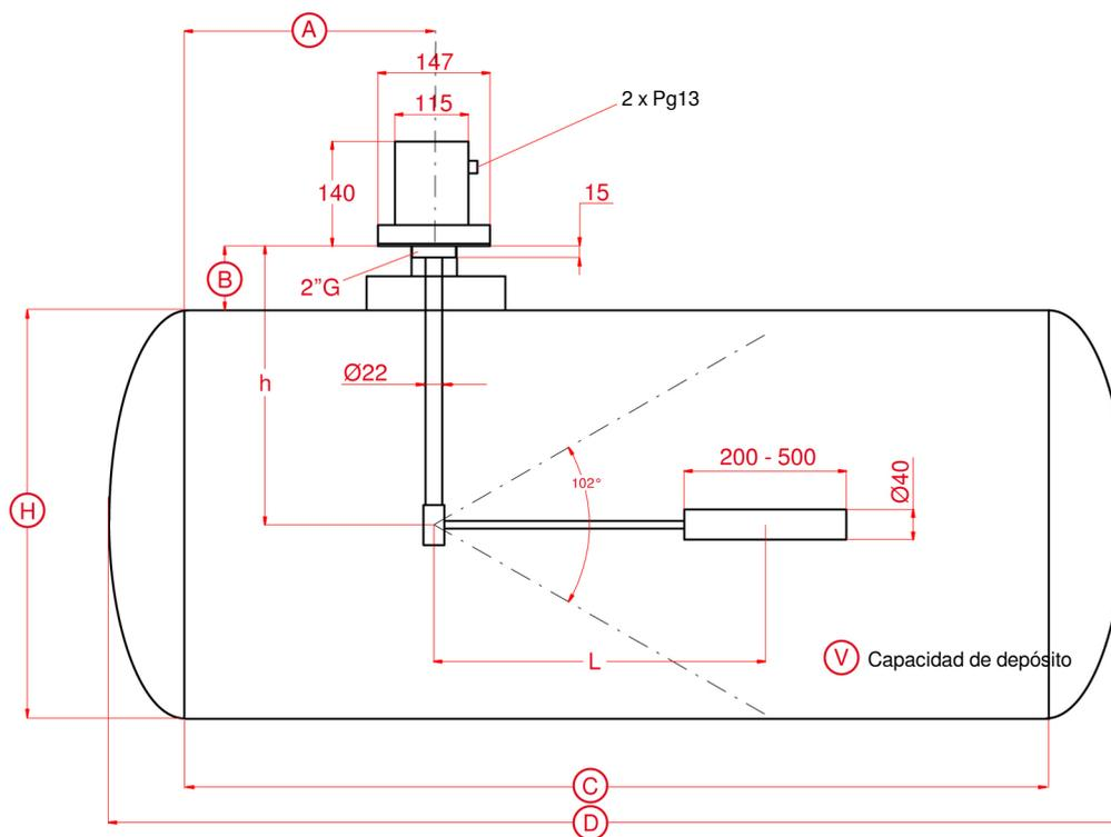
Las cotas A, B, C, D, H y la capacidad del depósito (V) deben ser suministradas por el cliente. Si el depósito tiene una forma rectangular, el cliente debe igualmente indicar su ancho.
