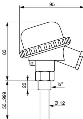
Modelo con cabezal en PVC
